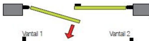
9. Dès que le vantail 1 atteint la butée d'ouverture, le vantail 2 (vantail battu) s'ouvre.
