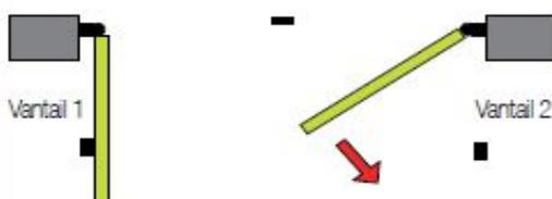
10. Lorsque les 2 vantaux sont arrêtés en butée d'ouverture, l'apprentissage est terminé :
